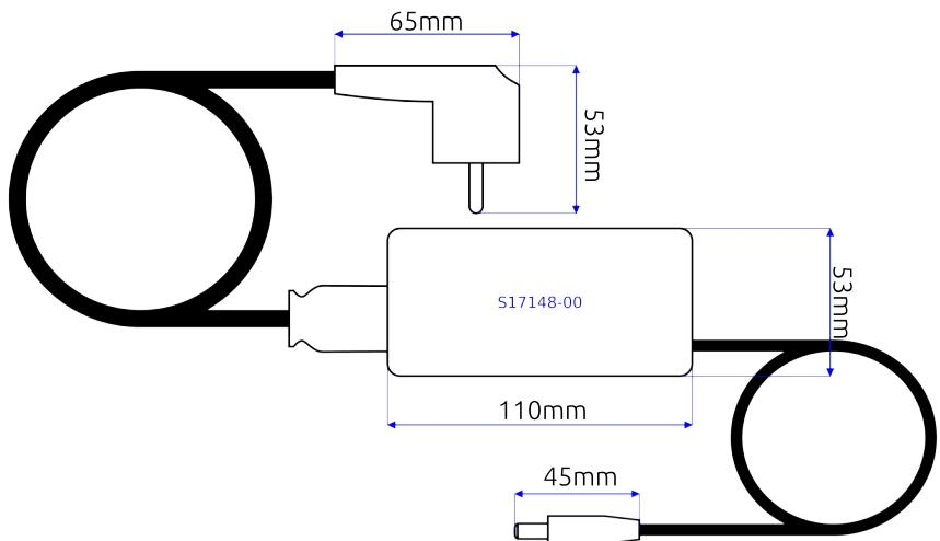
**Caractéristiques électriques et mécaniques****S17148-00**
