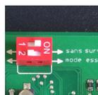
Si la détection de position des volets «**attente/ sécurité**» n'est pas nécessaire, alors basculer l'interrupteur «1» du switch SW sur «**sans surv. trappes**».
